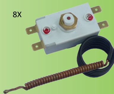
2-poliger Thermostat mit manueller Rückstellung, hoher Grenzwert, ausfallsicher, feste Einstellung, Temperaturbereich bis 170°C
