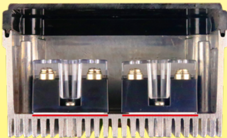
Installationsbeispiel für Halbleiterrelais in einem Ultiheat Aluminium-gehäuse (Wärmeleitpaste in rot)
